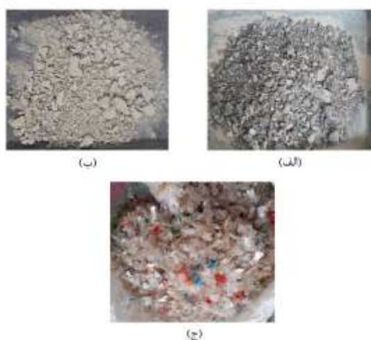
شکل ۳. مصالح بازیافتی ساختمانی: الف. بتن، ب. آجر و ج. PET Fig. 3. Construction and Demolition Waste: a. Concrete, b. Brick, c. PET
