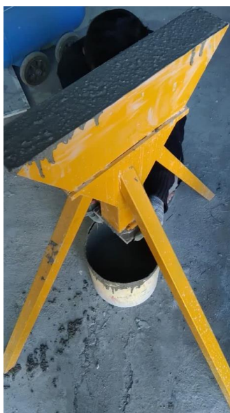
شکل ۴. آزمایش قیف V شکل
