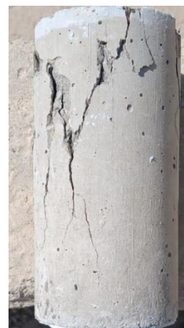
شکل ۷. شکست فشاری نمونه
