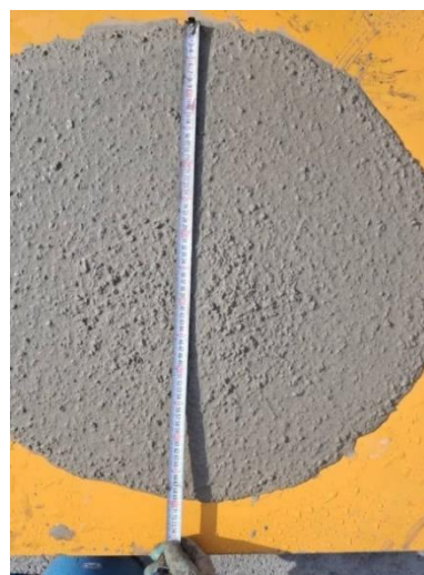
شکل ۳. آزمایش جریان اسلامپ Fig. 3. Slump flow test
