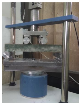
شکل ۶. آزمایش خمش چهار نقطه ای
