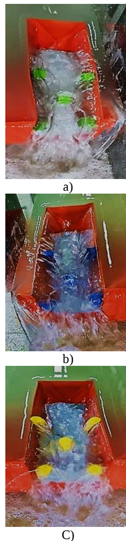
شکل ۵. الف) بلوک‌های مستطیلی، ب) بلوک‌های دوزنقه‌ای و ج) بلوک‌های دایره‌ای نصب شده روی سازه‌ی تونلی
