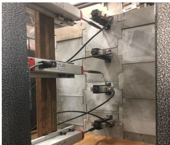
شکل ۷. نمایی از ابزار دقیق‌های نصب شده روی دیوار مدل
