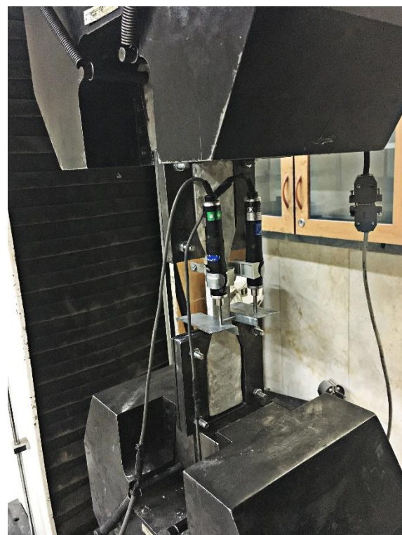
شکل ۵. چیدمان کشش مستقیم Fig.5. Direct tensile test setup
