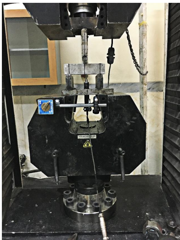
شکل ۶. چیدمان خمش سه نقطه‌ای Fig.6. Three point bending test setup
