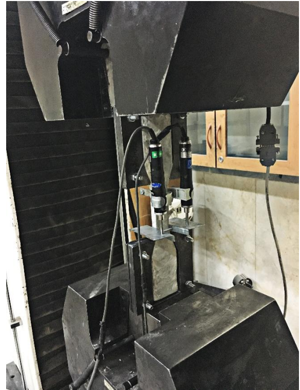
شکل ۵. چیدمان کشش مستقیم Fig.5. Direct tensile test setup
