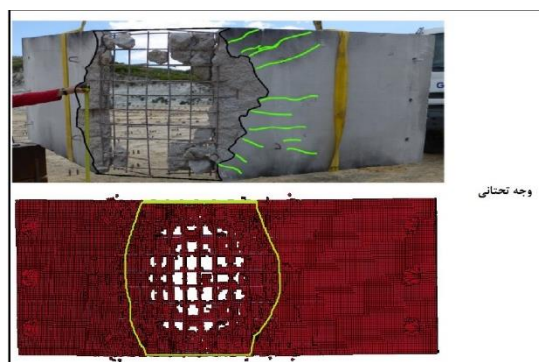
شکل ۱. مقایسه خرابی وجه تحتانی در مدل تجربی [۱۸] و مدل عددی
