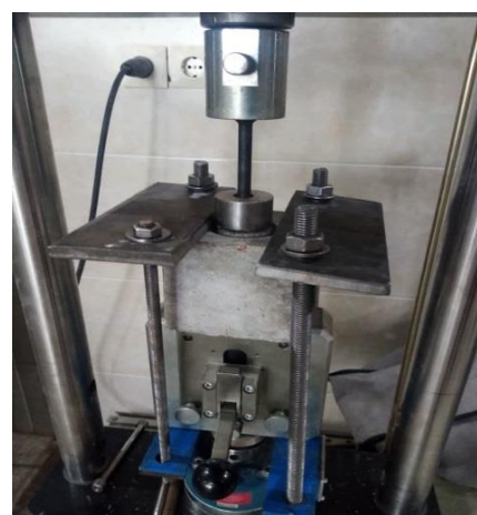
شکل ۵. پیکربندی آزمایش کشش از سطح Fig. 5. Pull off test set-up
