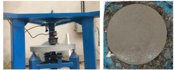
شکل ۵. روش تهیه و آزمون نمونه‌های خمشی
