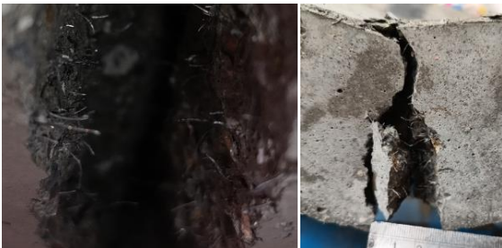
شکل ۱۰. پارگی الیاف تحت خمش در طرح WHSFSH-0%
