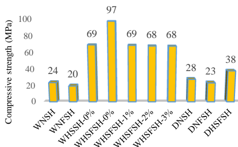
شکل 6. مقاومت فشاری 28 روزه طرح اختلاط‌های بتن پاششی Fig. 6. 28-day compressive strength of sprayed concrete
