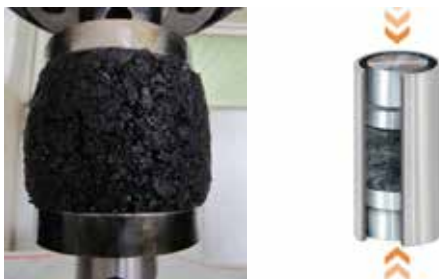
شکل ۴: روش ساخت و شکست نمونه‌ای آزمایش مقاومت فشاری
