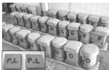
شکل (۵) نمای کلی نمونه‌ها با کلاهک عایق و صفحات عایق
