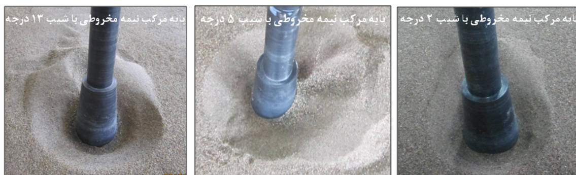
شکل (۸) فرسایش بستر ۳۵ ساعته برای مدل‌های نیمه مخروطی با قطر ثابت در بستر
