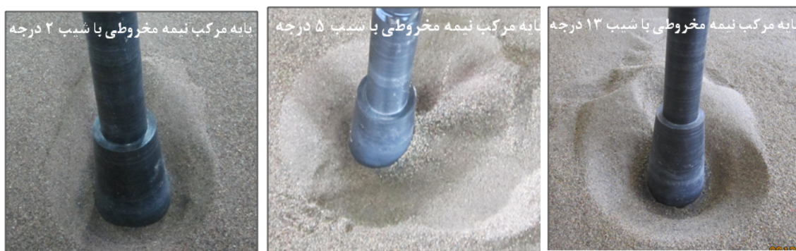
شکل (۶) فرسایش ۳۵ ساعته بستر برای مدل‌های نیمه مخروطی با قطر متغیر در بستر
