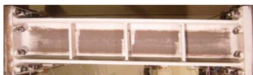
الف) نمونه مورد آزمایش و شرایط مرزی آن
