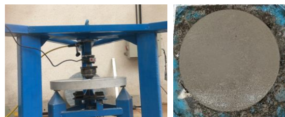
شکل ۵. روش تهیه و آزمون نمونه‌های خمشی
