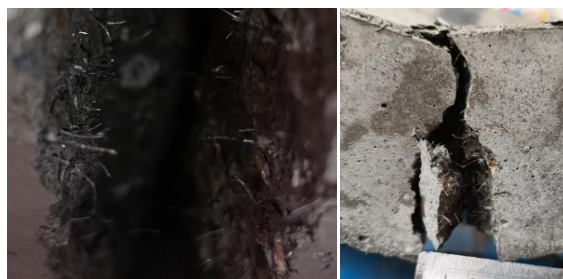
شکل ۱۰. پارگی الیاف تحت خمش در طرح WHSFSH-0%
