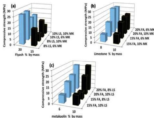
شکل ۱- اثر (الف) خاکستر بادی، (ب) سنگ آهک، (ج) متاکائولن بر مقاومت فشاری اتصال دهنده‌های پودرآهن [1]
