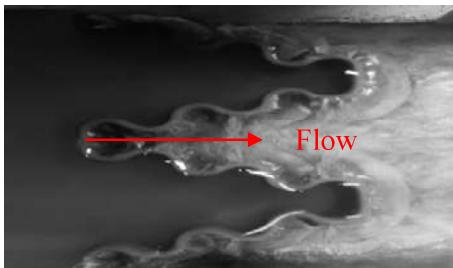
Fig. 3. Sinusoidal weir
