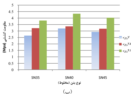
نمودار (۲) (الف) مقاومت کششی بتن مرجع، (ب) مقاومت کششی بتن نانوسیلیسی
