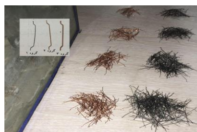
Fig. 1. Different types of steel fibers (groups 1, 2, and 3) with different specifications for making RPC samples الیاف فولادی مصرفی در این مطالعه، از شرکت تولیدی فولاد الوند که همگی ساخت کشور ایران و هماهنگ با
