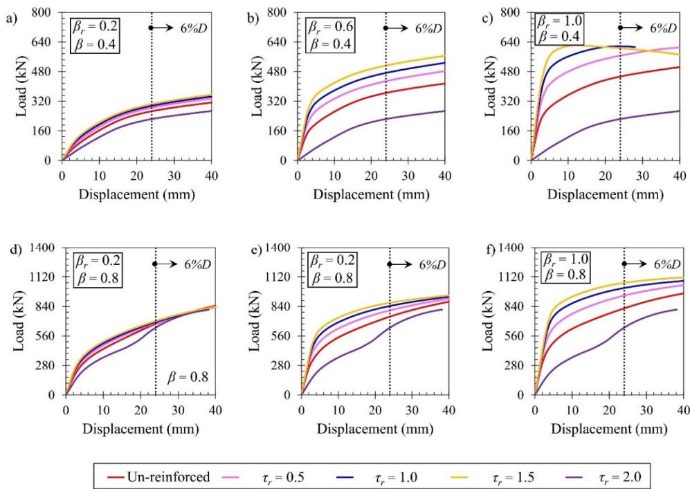
Fig. 6. The effect of the  $\beta$  on the initial stiffness and ultimate strength.شکل ۷. تأثیر پارامتر  $\beta$  روی مقادیر مقاومت نهایی و نسبت‌های مقاومت نهایی.
