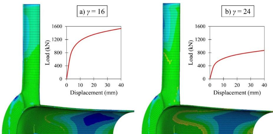
Fig. 10. The effect of the  $\gamma$  on the failure mechanism.شکل ۱۱. تأثیر پارامتر  $\tau$  روی مقادیر مقاومت نهایی.
