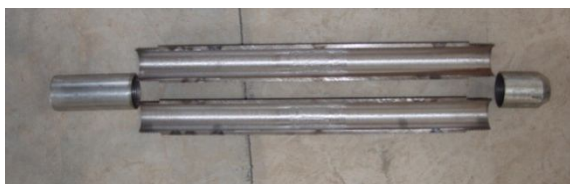
ر) نمونه‌گیر در حالت باز شده بدون مخروط نوک
