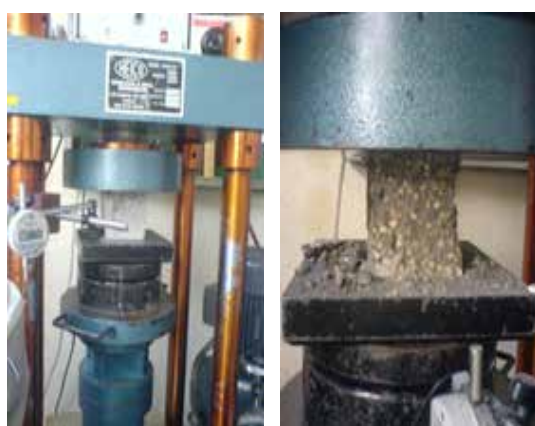
شکل ۲ آزمایش مقاومت فشاری و مدول الاستیسیته
