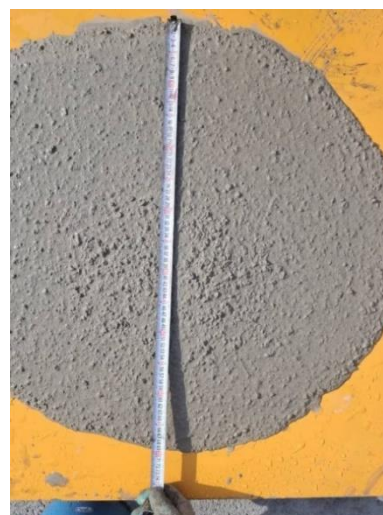
شکل ۳. آزمایش جریان اسلامپ Fig. 3. Slump flow test
