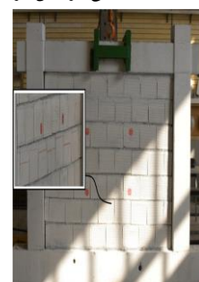
(الف) محل ترک ایجاد شده در پایین نمونه (جابه‌جایی ۱۸،۸۹ میلی‌متر)
