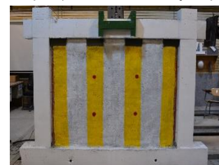
(پ) نمونه با والپست، تقویت شده با الیاف شیشه
