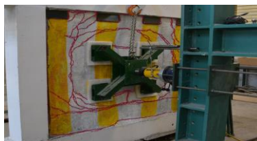
(پ) شمای نمونه تقویت شده پشت نمونه بعد از بارگذاری (جابه‌جایی ۵۰ میلی‌متر)
