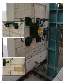
(ب) ترک ایجاد شده در پشت نمونه (جابه‌جایی ۲۱،۲۵ میلی‌متر)
