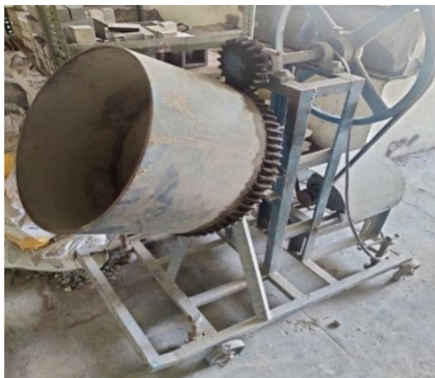
شکل ۲. دستگاه گلوله ساز [7]
