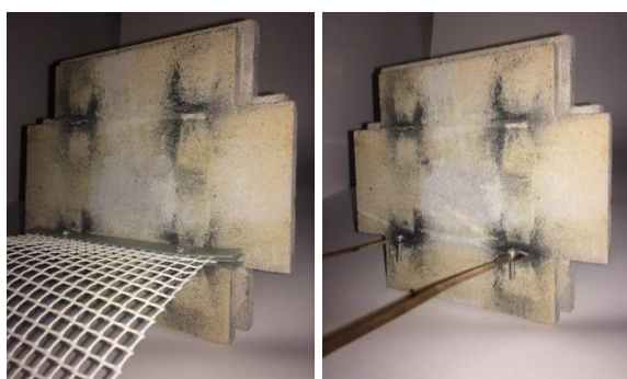
شکل ۴. تصاویری از رویه بتنی صلیبی به همراه المان‌های تسلیح
