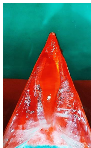
شکل ۵. ناحیه استغراق موضعی در کلید خروجی
