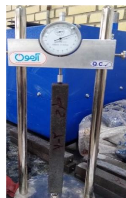
شکل ۴. دستگاه اندازه گیری جمع شدگی Fig. 4. Shrinkage measuring device
