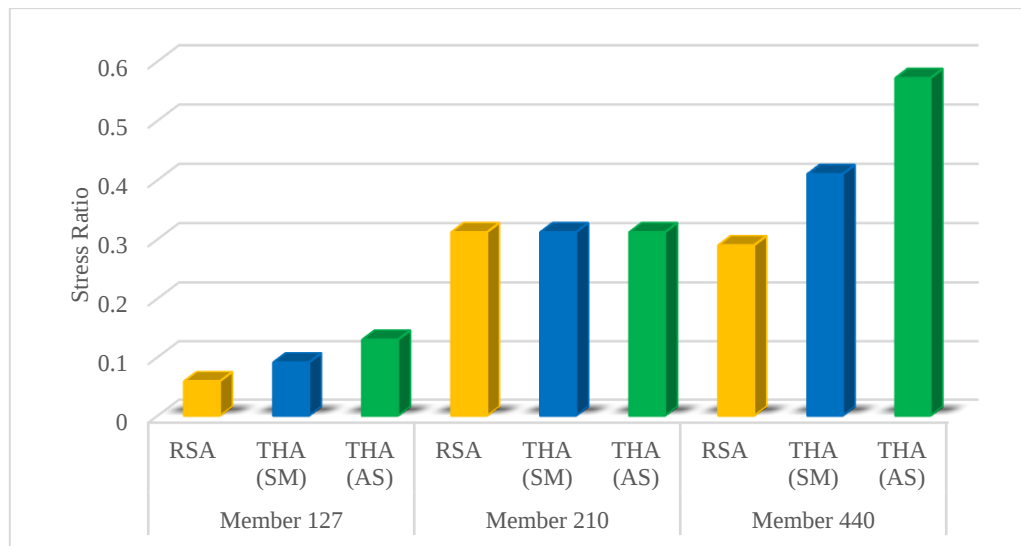
شکل ۱۲. مقادیر نسبت تنش در سه عضو گوناگون گنبد اشودلر به کمک دو نوع تحلیل
