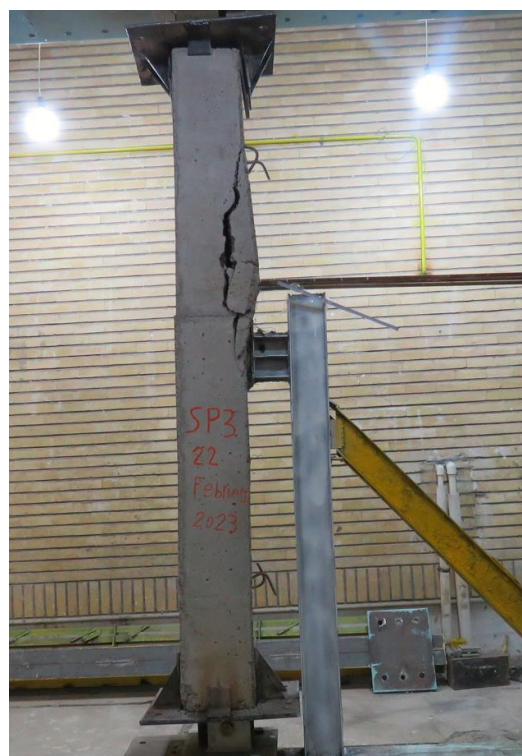
شکل ۱۰. افزایش عمق ترک‌ها در هنگام آزمایش برای نمونه شماره سه Fig. 10. Crack depth increase during testing in SP 3
