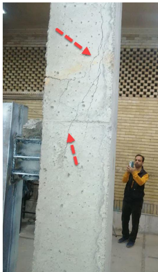
شکل ۹. نمونه شماره ۲ ترک‌هایی با زاویه نزدیک ۹۰ درجه Fig. 9. SP 2 and cracks with an angle close to 90 degrees
