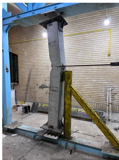
شکل ۸. نمونه شماره ۱ و جداشدن پوشش پشتی ستون
