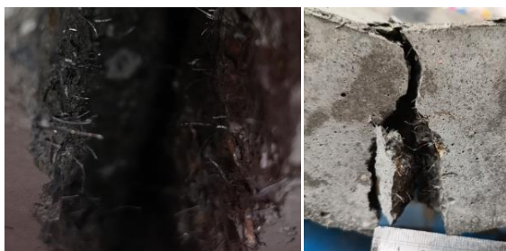
شکل ۱۰. پارگی الیاف تحت خمش در طرح WHSFSH-0%
