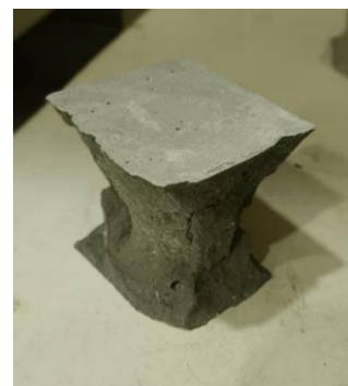
شکل ۶. نمونه بتنی بعد از انجام آزمایش مقاومت فشاری
