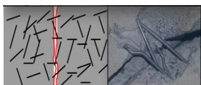
شکل ۱. نمایی از پخش شدن الیاف و قرارگیری آنها در عرض ترک
