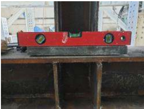
شکل ۴. استقرار ستون و ورق انتهایی در پیکربندی آزمایش
