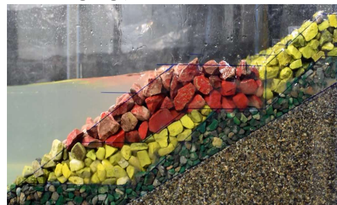
الف- نیم‌رخ سطح آب در حین بالاروی موج
