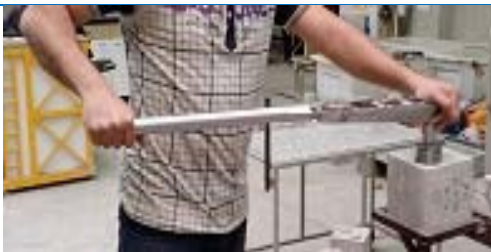
شکل ۲-ب. مغزه شکسته شده
