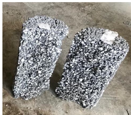
Fig. 1. Fractured specimen in splitting tensile strength تعیین جذب آب نمونه‌ها طبق استاندارد ASTM C642 [35] انجام شد. به دلیل تخلخل بالای بتن نفوذپذیر و حضور
