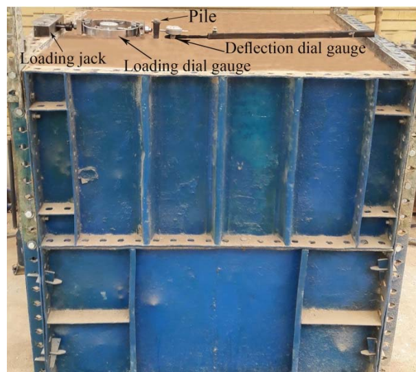
شکل ۳. دستگاه بارگذاری مورد استفاده، (الف): اجزاء دستگاه، (ب): نمای دستگاه
