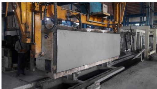
پ) هدایت قالب با جرثقیل به سمت خط برش
