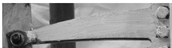
شکل ۷: تسلیم هم‌زمان تارهای بیرونی در طول دندان‌ها
