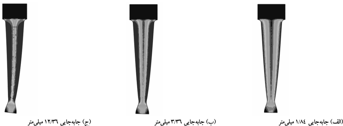
شکل ۳: توزیع تنش در طول دندان در گام‌های مختلف بارگذاری
