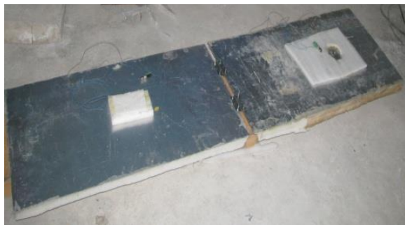
شکل (۲) مدل دو جزئی سازه شناور که با دو لولا به هم وصل شده اند، طول هر جزء یک متر است.
