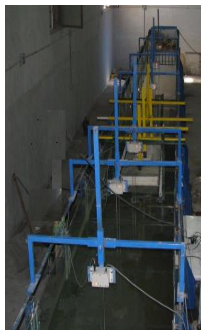
شکل (۴) نمایی از فلوم آزمایشگاه دانشگاه تحصیلات تکمیلی صنعتی و فناوری پیشرفته با طول ۱۶ متر، عرض و ارتفاع یک متر
