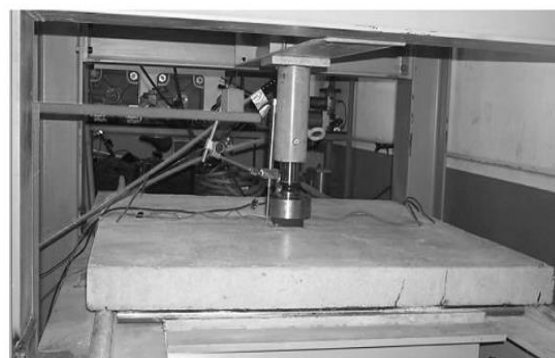
شکل (۲) دال آزمایش شده به وسیله آگاسو و همکاران [۵]
