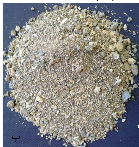
شکل (۲) (الف) مقایسه نمودار دانه بندی ماسه کربناتی بوشهر و ماسه کوارتزی تایورا (ب) عکس ماسه بوشهر
