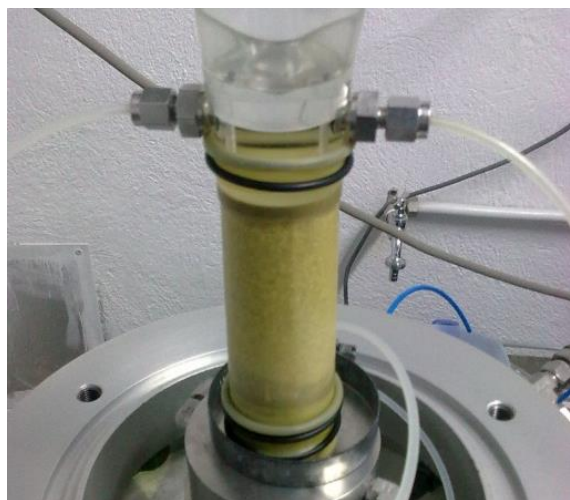
شکل (۳) نمونه آماده شده قبل از قرار دادن سلول و پر کردن سلول از آب
