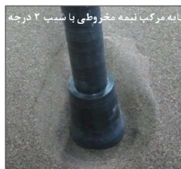
شکل (۸) فرسایش بستر ۳۵ ساعته برای مدل‌های نیمه مخروطی با قطر ثابت در بستر
