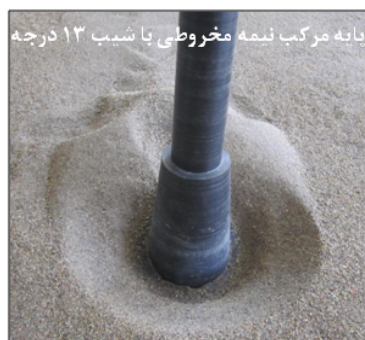
شکل (۸) فرسایش بستر ۳۵ ساعته برای مدل‌های نیمه مخروطی با قطر ثابت در بستر
