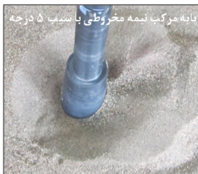
شکل (۸) فرسایش بستر ۳۵ ساعته برای مدل‌های نیمه مخروطی با قطر ثابت در بستر
