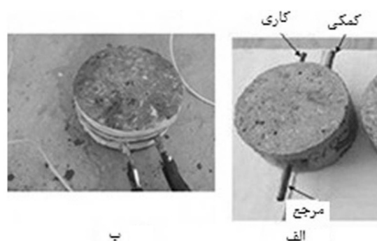
شکل (۱) الف) نمونه‌های بتنی بعد از برش ب) طبقه اعمال ۳۸۰ ولت متناوب
