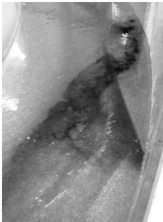
شکل (۳) نمایش انحراف جریان از ساحل بیرونی به طرف مرکز مجرا به وسیله آبشکن مثلی به ازای زاویه ۲۳ درجه با استفاده از ماده رنگی
