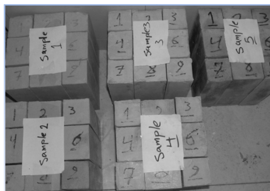
شکل (۲) بلوک‌های مکعب مستطیل ساخته شده با ویژگی‌های مکانیکی گوناگون
