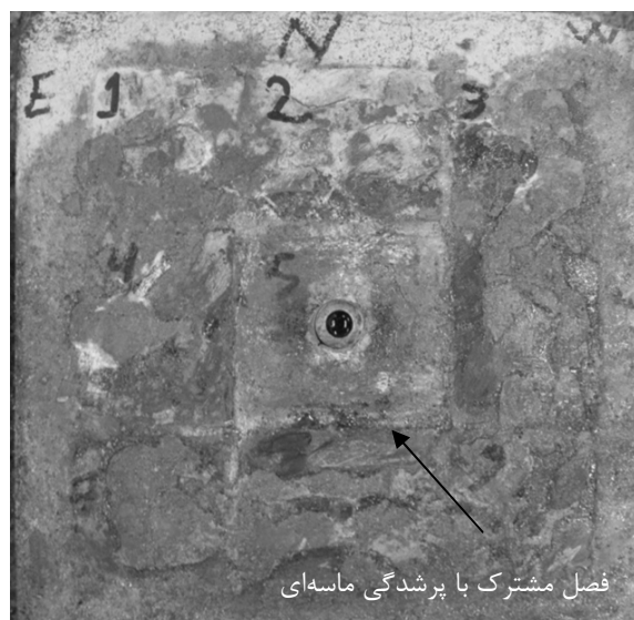
شکل (۱۶) نمای کلی نمونه ۳ و تراوش سیال به بالای نمونه پس از برخورد شکستگی هیدرولیکی به فصل مشترک ماسه‌ای
