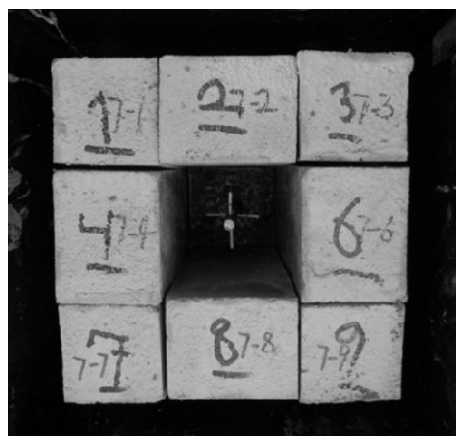
شکل (۳) چیدمان بلوک‌های کوچک‌تر در بلوک بزرگ‌تر و محل قرارگیری گمانه فلزی میان آن‌ها
