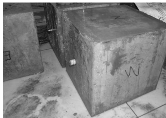
شکل (۶) بلوک‌های بزرگ ساخته‌شده پس از خروج از قالب
