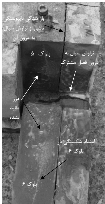
شکل (۸) امتداد شکستگی منتشرشده در بلوک مجاور و چگونگی تراوش سیال به درون فصل مشترک لایه‌ها در نمونه ۱
