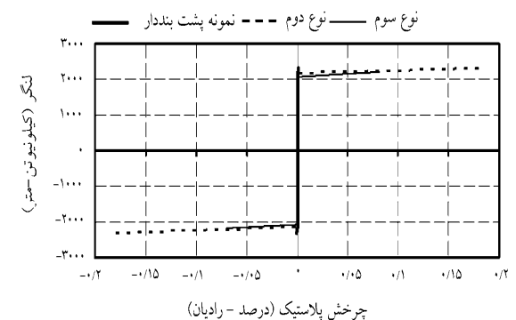
شکل ۲۸ نمودار پوش لنگر مرز تیر و ستون - چرخش پلاستیک چشمه اتصال
