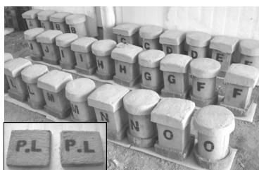
شکل (۵) نمای کلی نمونه‌ها با کلاهی عایق و صفحات عایق
