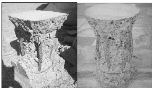
شکل (۸) چگونگی گسیختگی در نمونه‌های دایره‌ای و مربعی
