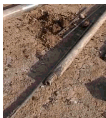
شکل (۴) یک میله نفوذ و سوزن آن
