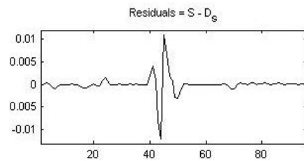
شکل (۱۵) برای پاسخ نمونه ترک‌دار تحت موجک آنالایزر Bior (Mode1-U2)
