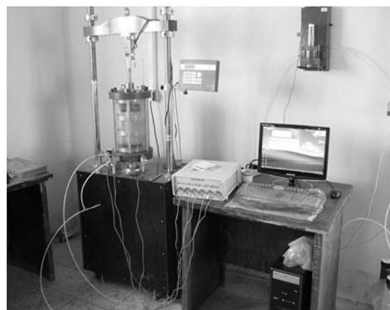
شکل (۲) نمایی از مصالح، دستگاه ادومتر و سلول سه‌محوری مسلح استفاده‌شده در انجام آزمایش‌ها
